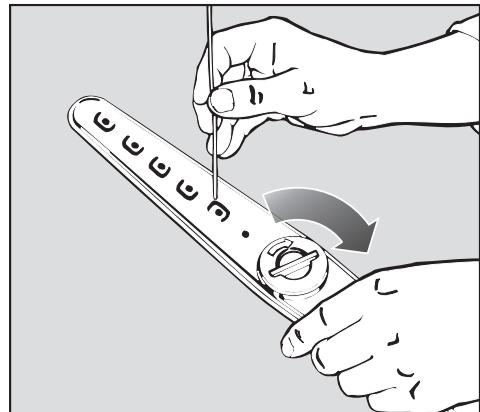
Reste im **unteren** Spülarm lassen sich leichter ausspülen, wenn die Verschlusskappe geöffnet wird.
