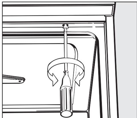
■ Linke und rechte Befestigungsschraube mit einem Schraubendreher herausdrehen.
