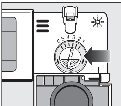
Der Dosierwähler (Pfeil) in der Einfüllöffnung ist von 1 bis 6 (1-6 ml) einstellbar. Werkseitig ist er auf "3" (3 ml) für die **Nachspülmitteldosierung** eingestellt.
