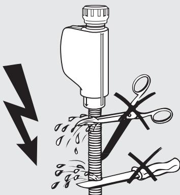
**⚠** Der Zulaufschlauch darf **nicht** gekürzt oder beschädigt werden (siehe Abb.!).
